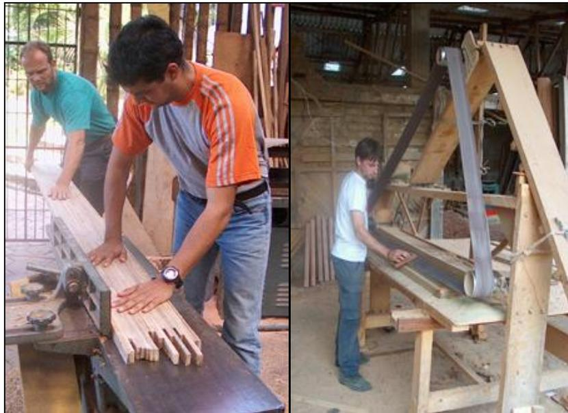
**Fig. 14: Cepillado y lijado del tablón laminado basándose en tablillas intercaladas.**
