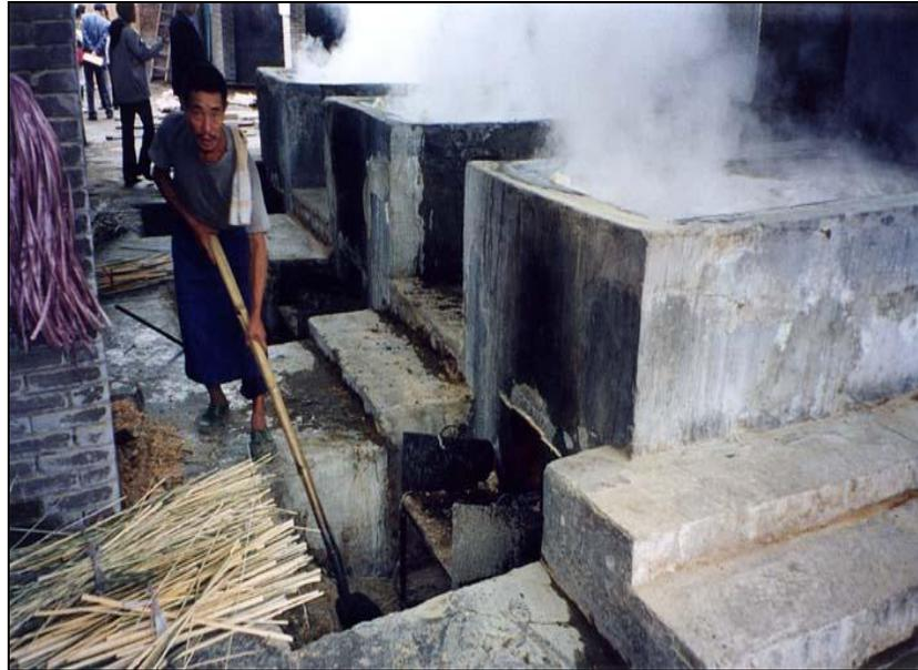
**Fig. 9: Blanqueamiento con  $H_2O_2$  en calderas de cemento en la producción de latas de bambú en Yibin (China).**
