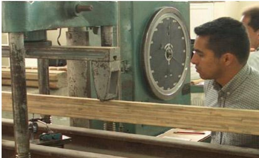
**Fig. 3: Viga laminada de 3 metros en ensayos de flexión, Manizales 2002.**
