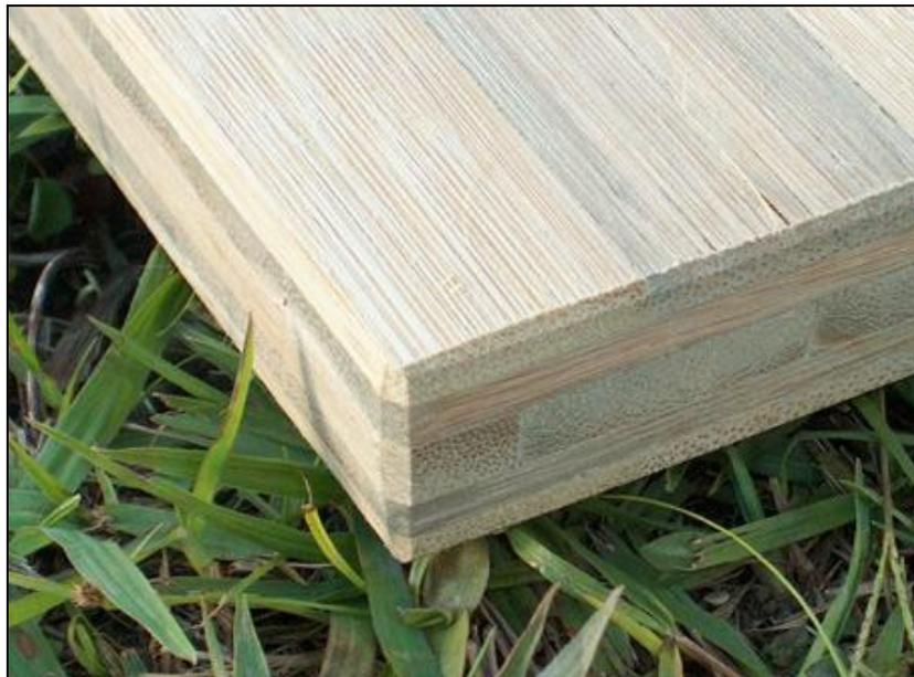
**Fig. 1: Paneles de cinco laminas en guadua, 30 mm espesor.**
