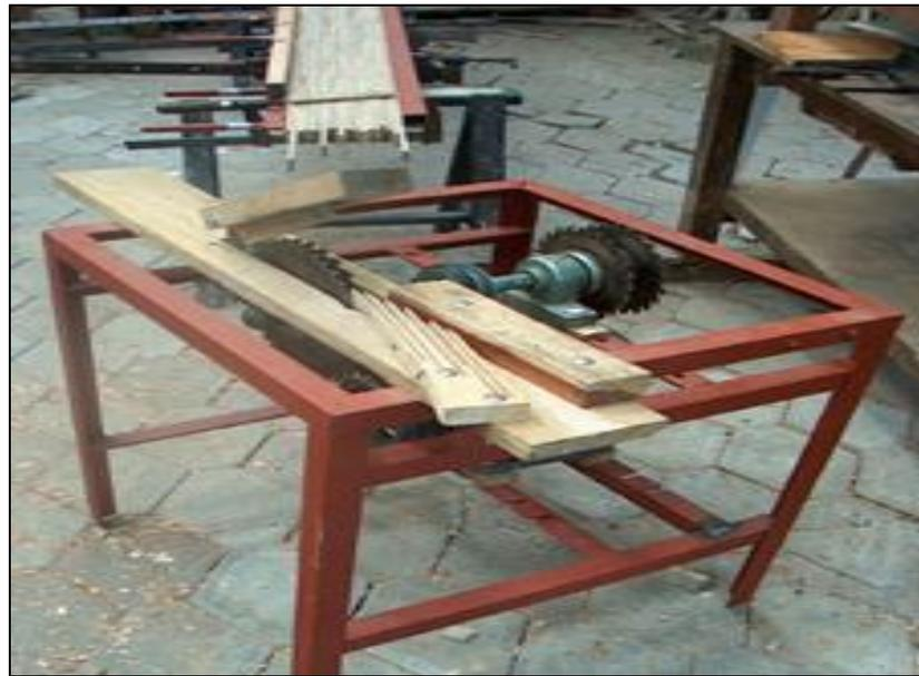
**Fig. 8: Corte de latas de guadua con sierra de disco paralelo y guía.**
