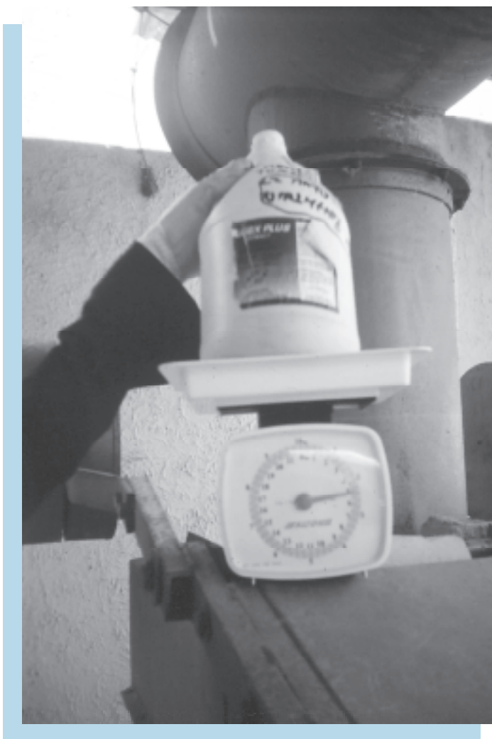
Foto 10. Pesaje de Residuos Cortopunzantes
