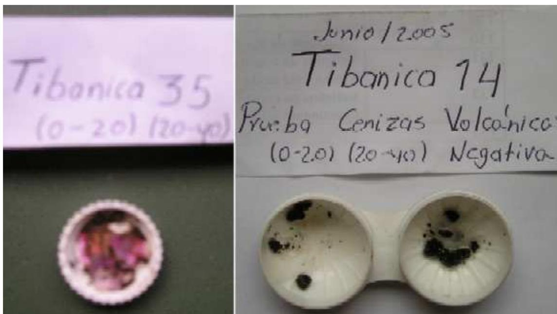
**Figura II-17.** Reacción típica en color lila por presencia de cenizas producto de quemas, reacción negativa en los suelos no alterados
