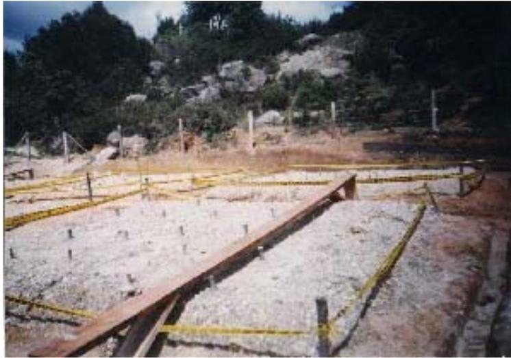
**Figura 13.** Banca utilizada en los muestreos para no compactar el suelo.
