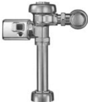
Trabaja con 4 baterías alcalinas o lithium. (+/- 3 años de servicio), usa cámara de engranaje, no usa válvulas solenoides. Sensores programables (distancia - lavado), modelo robusto. Caja anti vandálica. Para conexión a racor plástico o en bronce. Permite descarga manual. (Ver ilustración 25) (ACUAVAL, 2010)
