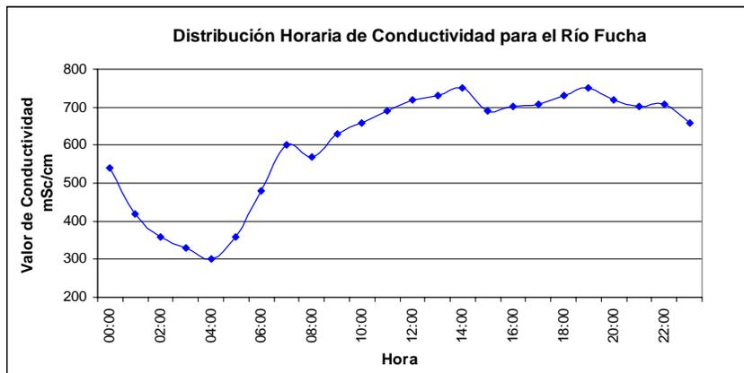
**Figura 5-2. Variación horaria de la conductividad utilizando los multiplicadores horarios de la Subcuenca del Virrey**
