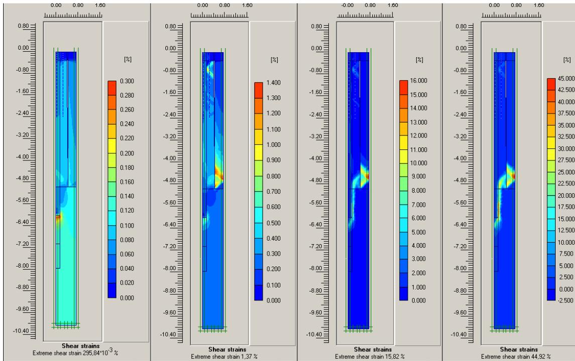
\*Los valores máximos de deformación por corte de izquierda a derecha alcanzan 0,29%, 1,4%, 15,8% y 45 %. Los valores máximos ocurren en la base de las grietas y a lo largo del contacto suelo estabilizado - arcilla blanda.
