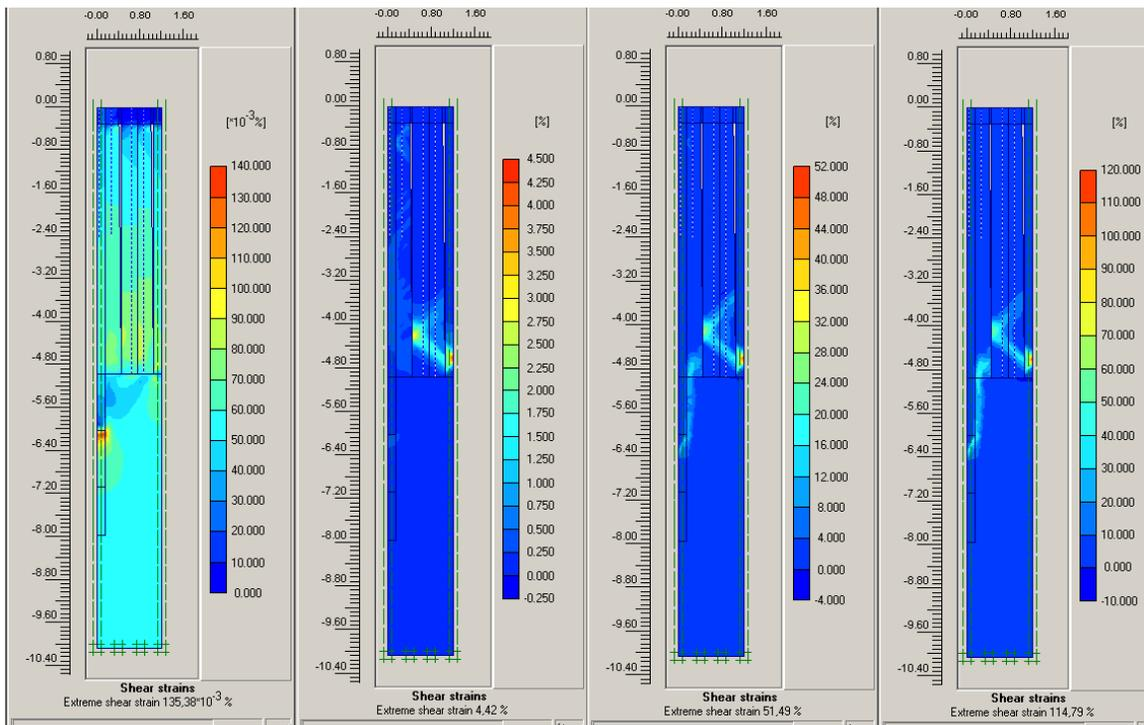
\*Los valores máximos de deformación por corte de izquierda a derecha alcanzan 0,13%, 4,4%, 51,4% y 114 %. Los valores máximos ocurren en la base de las grietas.
