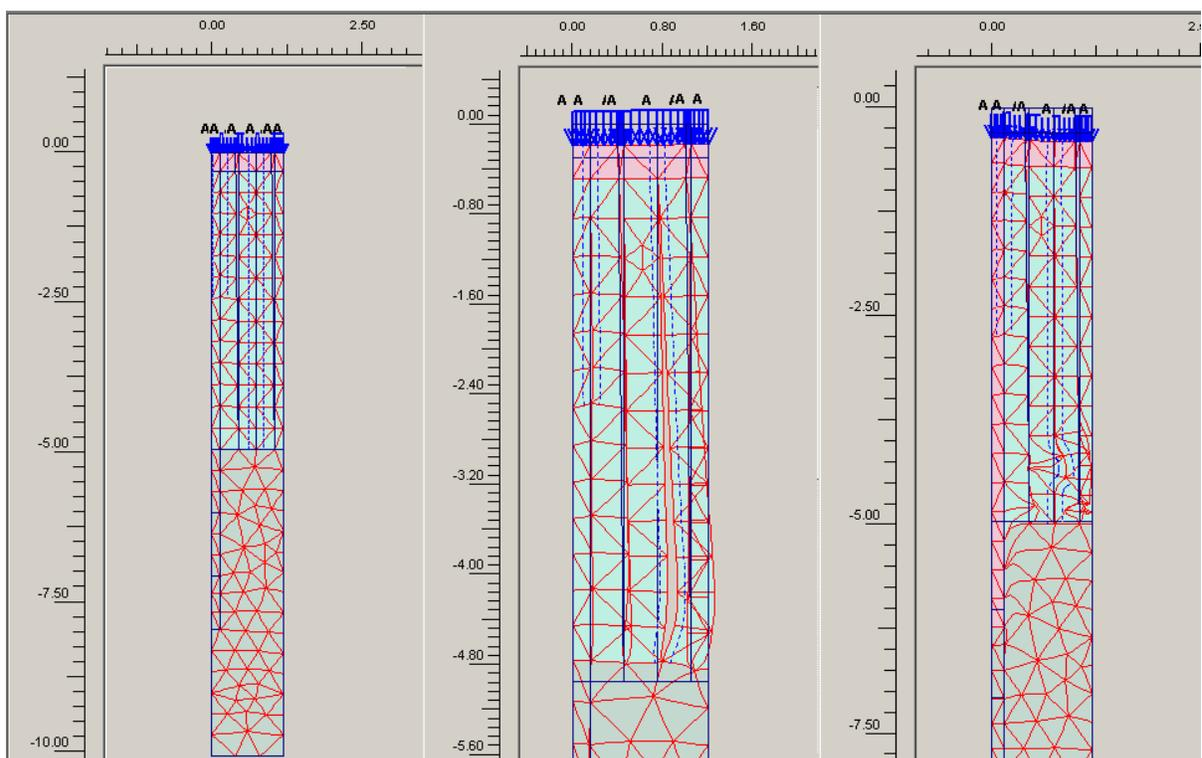
\* A la izquierda se ilustra la malla de elementos finitos y la asignación inicial de materiales. En la parte central se ilustra el patrón de deformaciones si se aplica la carga directamente sobre el suelo sin refuerzo, y a la derecha el modelo con la columna de suelo estabilizado.
