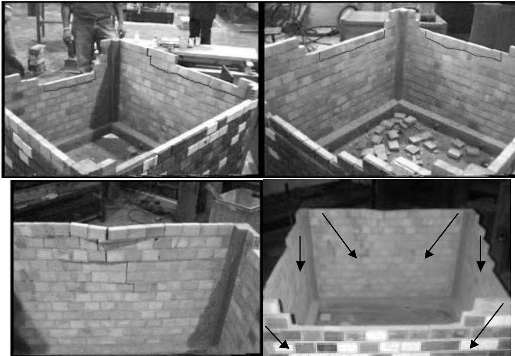
*Imagen 9.11 Similitud en el mecanismo de falla de todos los Muros*
