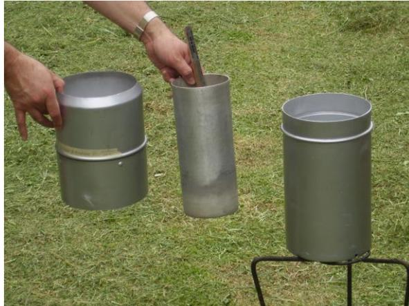
En la vista superior del pluviómetro, mostrada en la figura 9, se observa el receptor, tanque colector y la probeta dentro del colector
