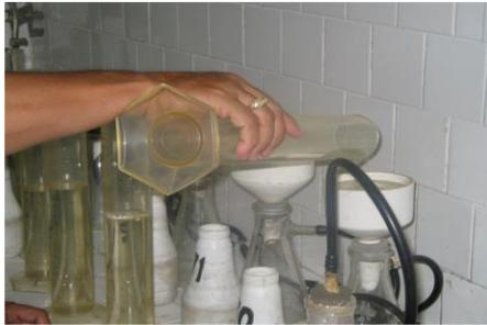
**Revisión de que no haya quedado sedimento en embudo, botella y probeta**
