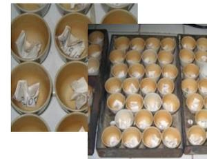
**Cargue de crisoles en mufla, hasta 600°C, 30 min, enfriamiento a 200°C, y retiro de crisoles**
