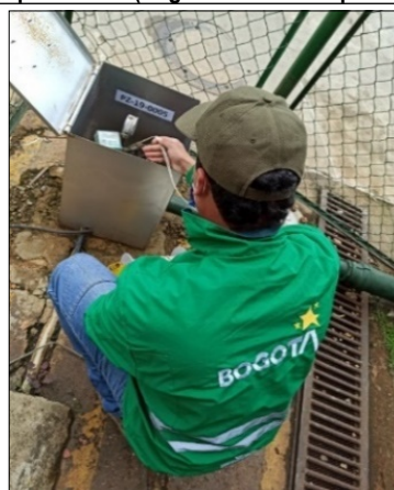
Fotografía 2. Medición del nivel estático del pozo pz-19-0005 (Frigorífico Guadalupe no. 1)-
