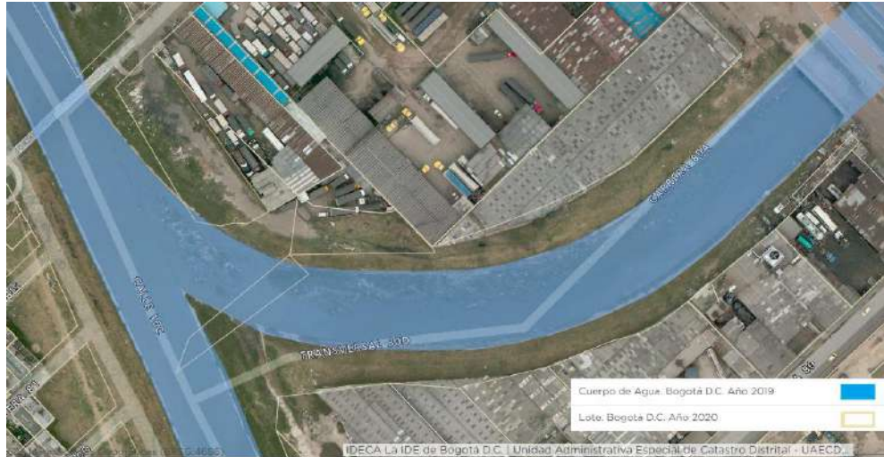
Mapa 15: Discriminación predial de los lotes que están generando la invasión del corredor ecológico de ronda en el Canal San Francisco aguas abajo de la Av. Calle 17 (Fotografía 57 a 59).
