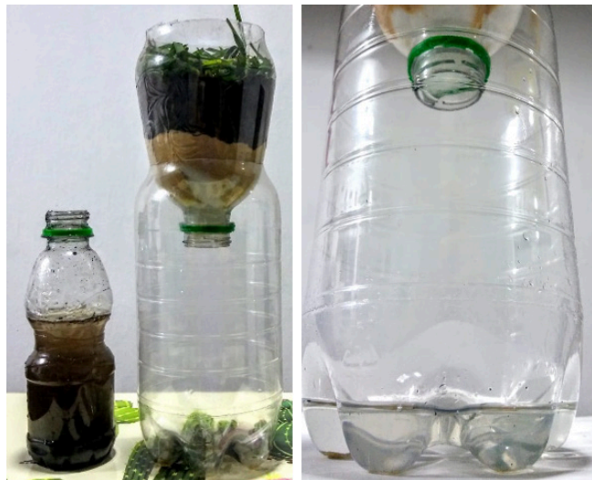
Ejemplo de montaje de filtro artesanal (al lado derecho se observa el agua a filtrar así como el filtro elaborado) y al lado izquierdo el resultado utilizando el filtro. Fuente: Helena Sepúlveda
