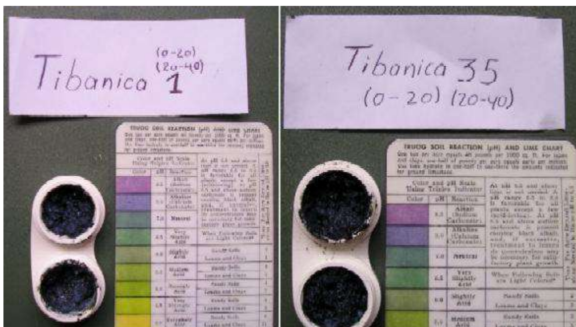
Figura II-16. Medición del pH de los suelos por reacción con indicador triple y sulfato de bario (reacción alcalina, pH=8)
