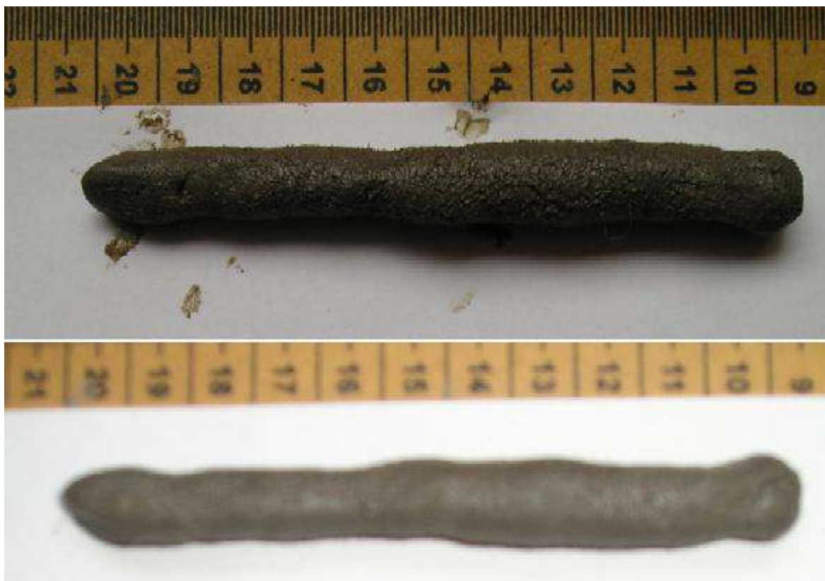
Figura II-18. Medición del coeficiente de expansión por rollo húmedo y seco (no hay mayor contracción)
