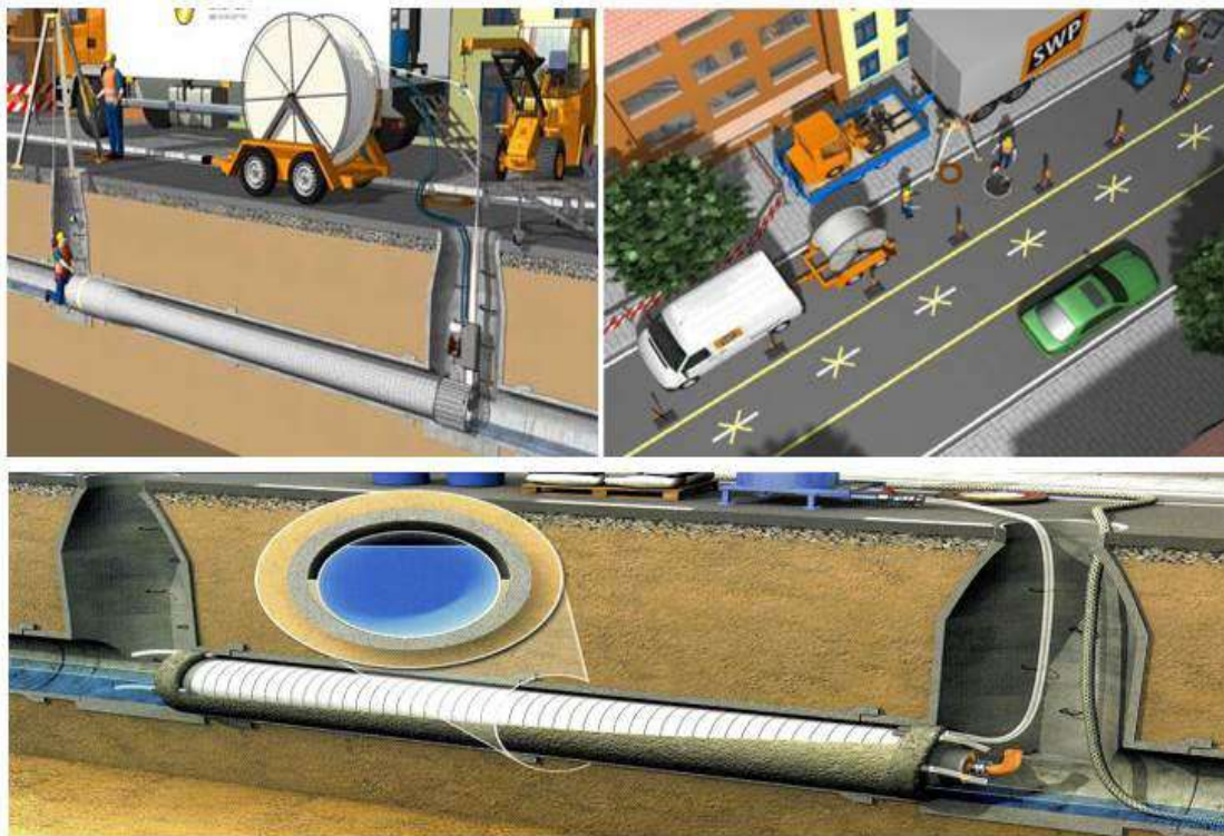
Imagen 52. Restauración de colectores la Vieja y las Delicias
