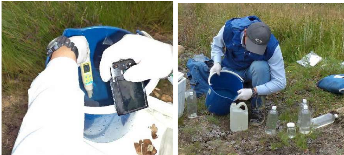
Fotografía 48 Toma de parámetros físico-químicos in situ
