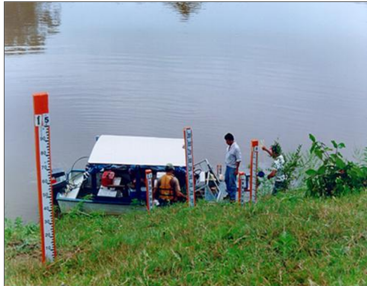
Figura 1. Mira hidrométrica (R. Atacuarí)
