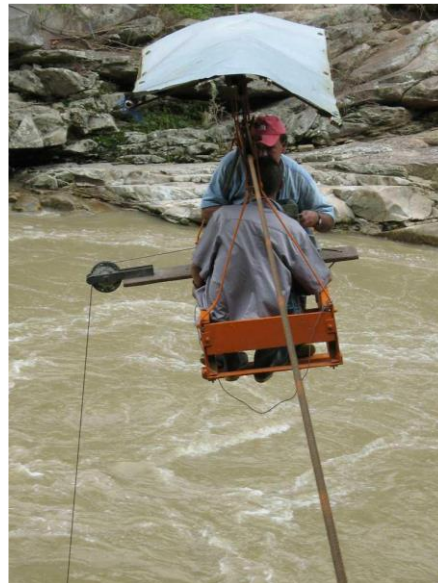
Figura 24. Tarabita monofilar para aforos
