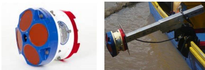
Figura 41. Ilustración del procedimiento de medición con medidores Doppler ADCP desde un bote
