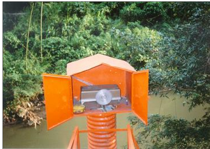
Figura 5. Limnógrafo mecánico río Ermi (Charcolargo)
