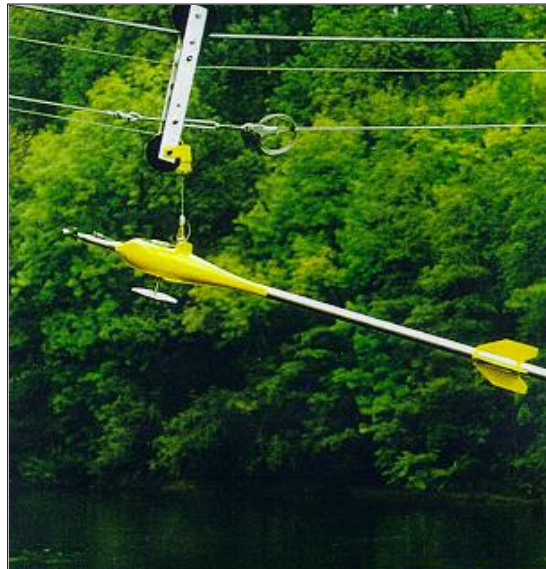
Figura 33. Tocador de fondo tipo SEBA
