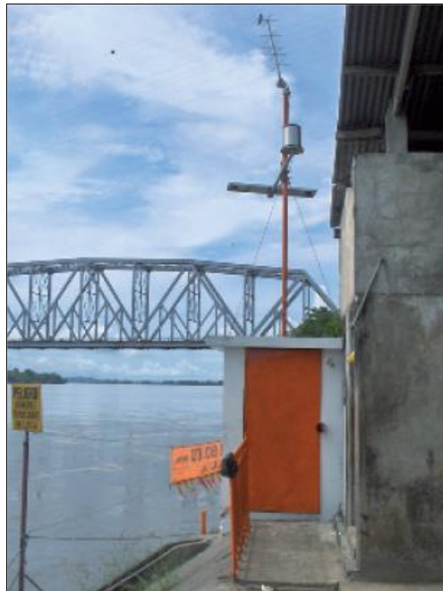
Figura 12. Imagen de una estación hidrológica con transmisión automática y satelital
