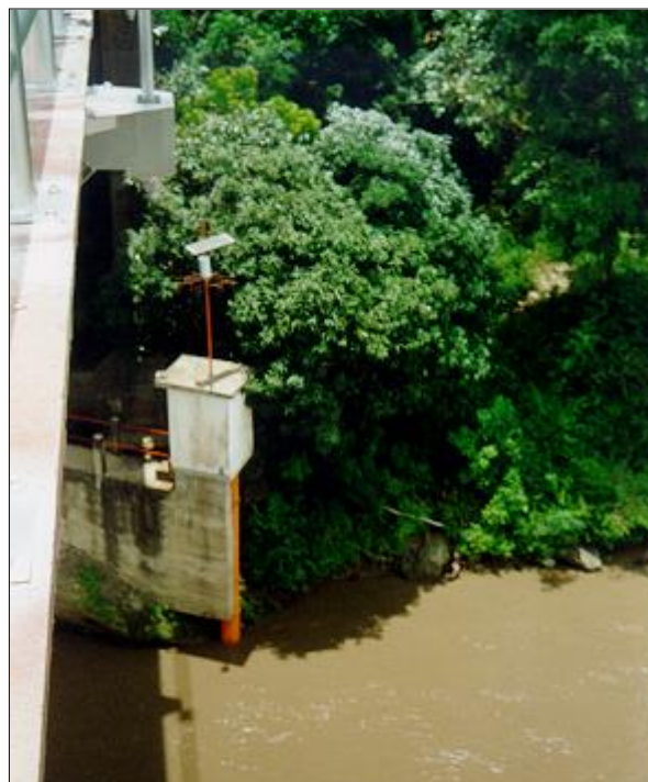
Figura 7. Limnógrafo digital, río Sogamoso, estación Puente La Paz
